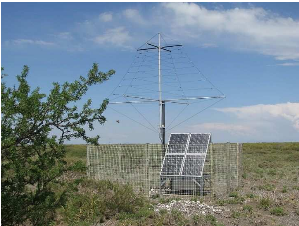
Rysunek 18: Stacja robocza eksperymentu AERA. Dipolowa antena pozwala na jednoczesne mierzenie polaryzacji wschód- zachód oraz północ-południe [82].
