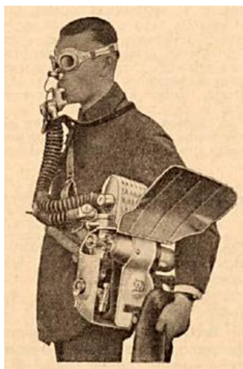
Aparat tlenowy automatyczno - płucny H. S. S. model 1924 r. , wyrób niemieckiej fabryki Draeger. Najbardziej popularny w Polsce. Źródło: Vademecum obrony przeciwlotniczej i przeciwigazowej... dz. cyt., s. 372.
