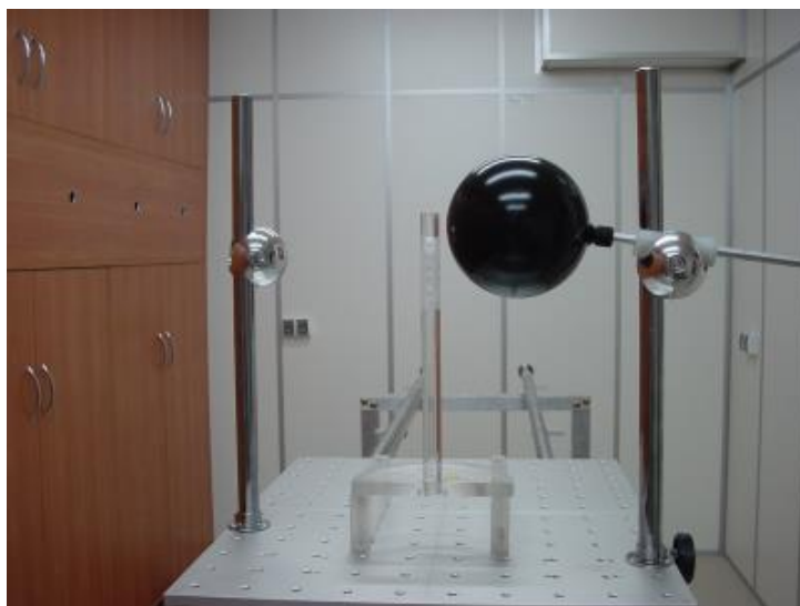
Rys 15. Stanowisko do wyznaczenia wartości H_p(0,07) .
