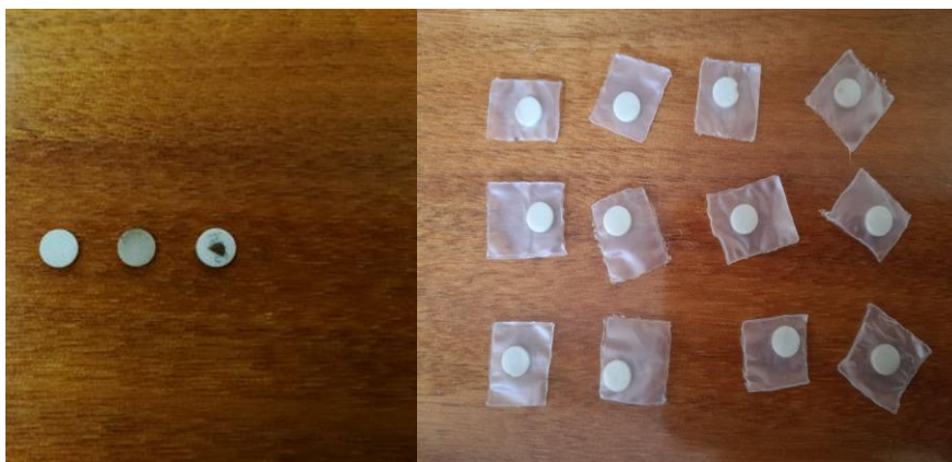
Rys. 19. a) Przykład zmienionej powierzchni detektora; b) detektory zapakowane w folię, przygotowane do pomiarów dozymetrycznych.
