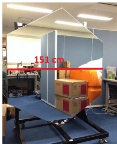
Rysunek 3.6. Lustra w LST. Z lewej ułożenie 198 luster w teleskopie, środek pozostaje pusty ze względu na cień rzucany przez kamerę. Z prawej – lustro używane w prototypie LST, w dolnym rogu widać otwór na kamerę CMOS. Obrazek zaczerpnięty z [57].
