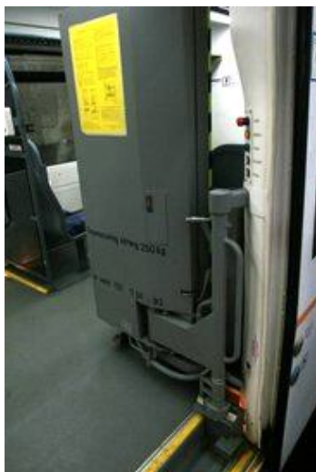
Fot. 6.25. Platforma dla wózków inwalidzkich w wagonie pociągu SKM (Źródło: zbiory autorów)
