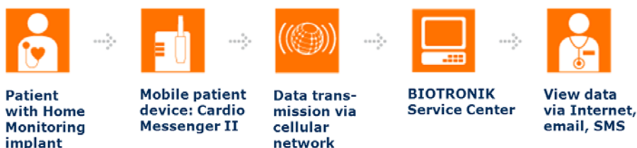
Rys. 3. Zasada działania systemu BIOTRONIK Home Monitoring®
