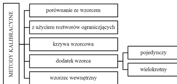
Rys. 1. Najczęściej stosowane metody kalibracyjne
